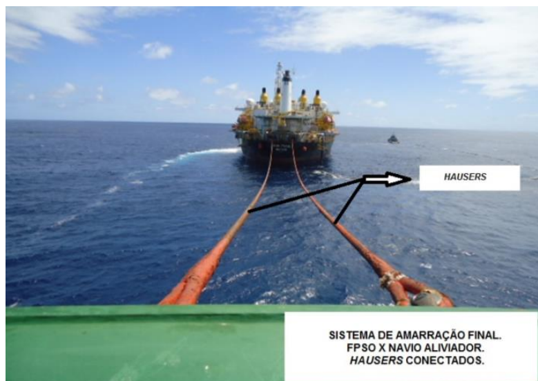
Figura 4. Amarração final para aproximação do navio aliviador.
